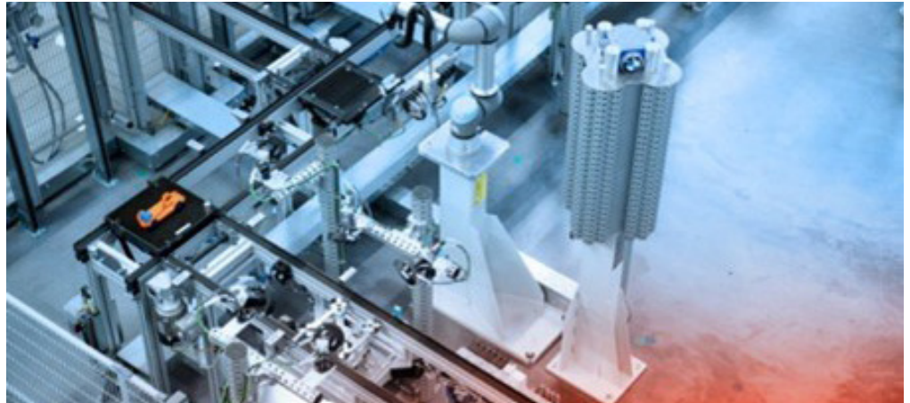
Abbildung 35: BMW-Testanlage eines Montagesystems mit Werkstückträgern und einer automatisierten Verkettung von mehreren Montage- und Prüfstationen.
