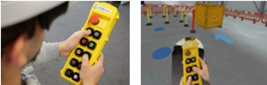
Abbildung 51: In der Anwendung wird eine reale Kran-Fernbedienung eingesetzt, die über Video-Passthrough in die Simulation eingebunden wird.
