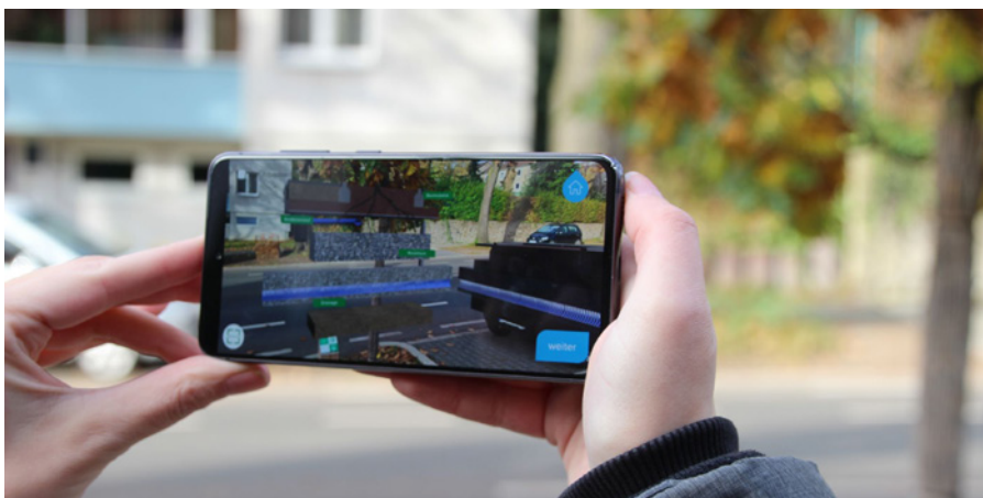
Abbildung 11: Das System der installierten Baumrigolen wird direkt im Live-Bild des Smartphones visualisiert.
