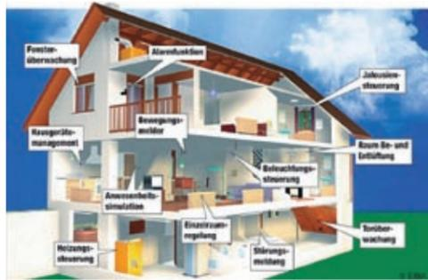
Abbildung 6 Darstellung der Automatisierungsmöglichkeiten bei einem Wohnhaus (Quelle: [http://www.eib-schoeller.de/images/WDB\\_EIB-Grafik.jpg](http://www.eib-schoeller.de/images/WDB_EIB-Grafik.jpg) Zugriff am 29.08.2008)
