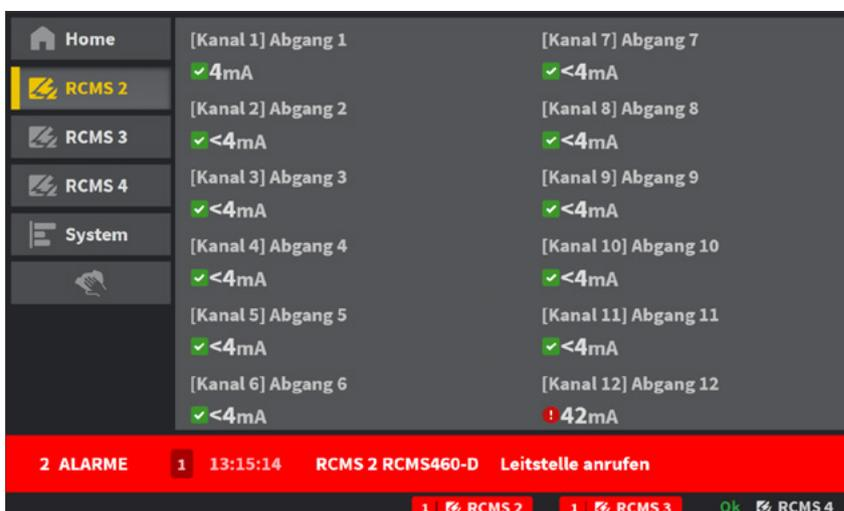
Abbildung 4: RCMS Visualisierung – Alarm: Überschreitung der Grenzwerte für RCMS
